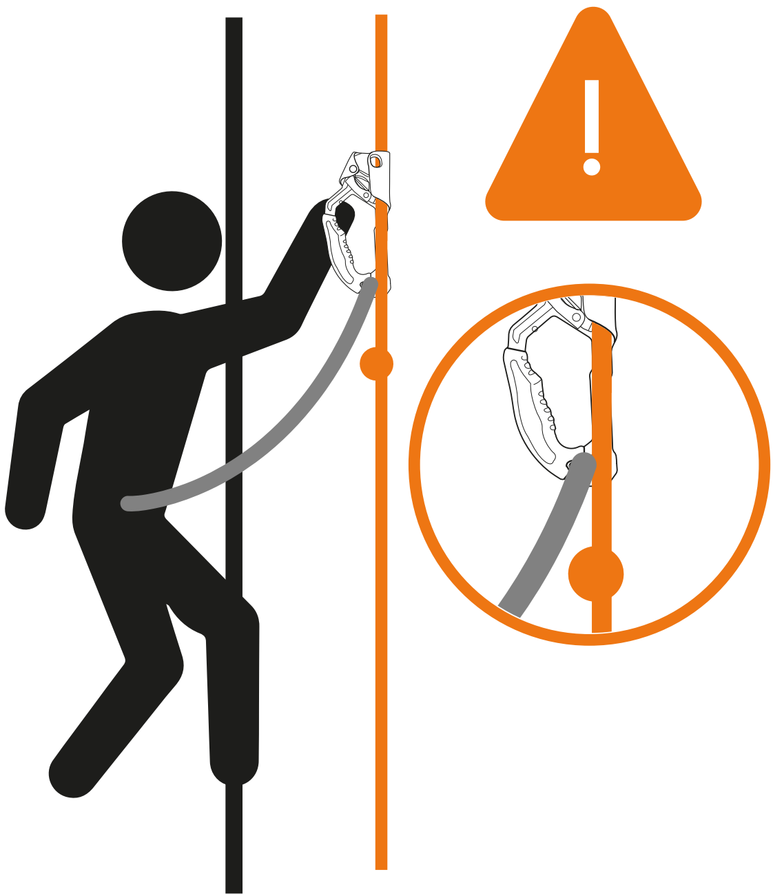
Objetos que obstruyan funcionamiento
